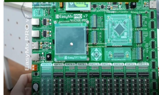
Плата EasyTFT с разрешением 320x240 пикселей, 2,83" цветной TFT-дисплей со светодиодной подсветкой и HX8347D контроллером
