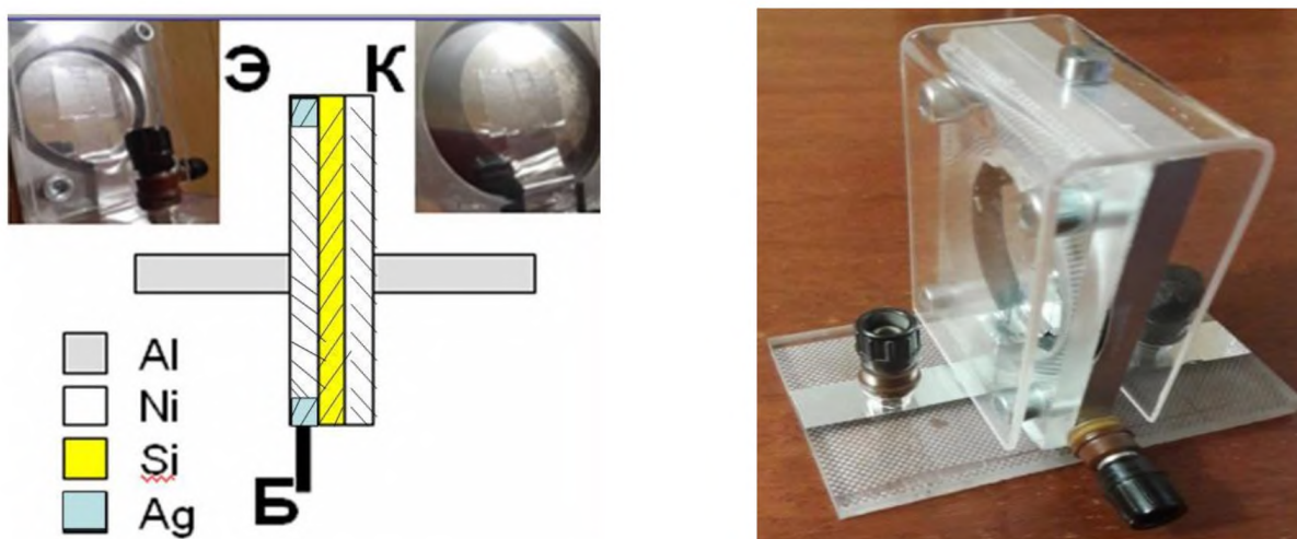
Рис. 3 а) сэндвич-структура транзистора; б) транзистор
