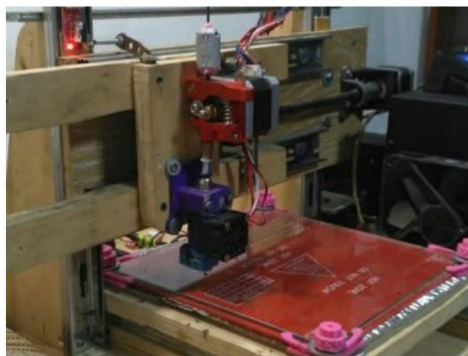
Рис. 4. Размещение блока экструдера и механизма подачи
