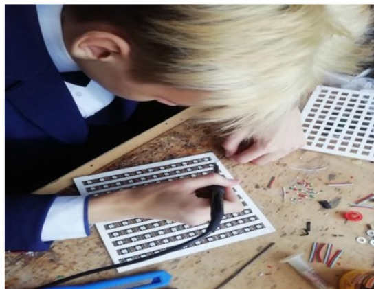
Рис. 1, 2. Панель со светодиодами и процесс пайки контактов
